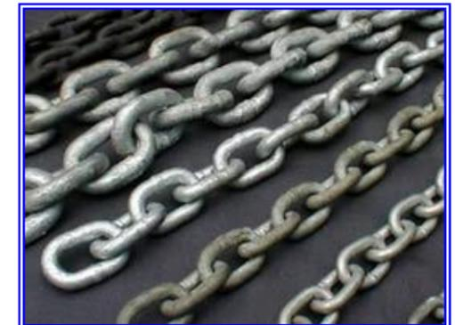
La carga de trabajo de estos medios auxiliares, es aquella que puede ser soportada por él, con toda seguridad. Este dato debe estar marcado con cifra o letras bien legibles, en el anillo de la eslinga o en una placa fijada por presión a uno de sus ramales.
